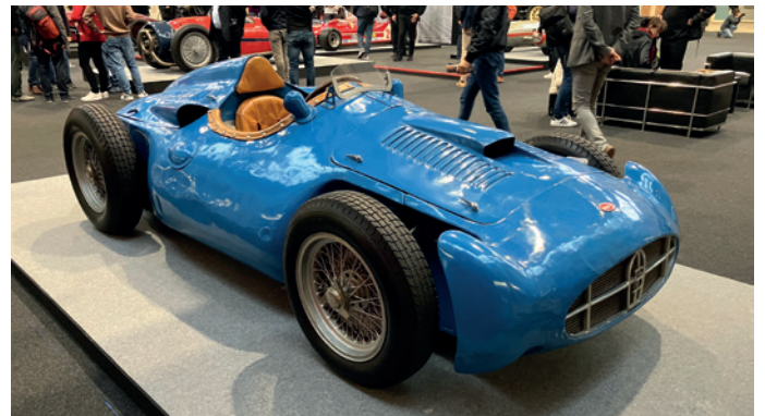
Der allerletzte Bugatti Typ 251 Grand Prix Wagen aus dem Jahr 1955/56, mit einem 2,5 Liter 8-Zylindermotor und 230 PS bei 8.000 U/min, aus der Collection Schlupf in Mulhouse
